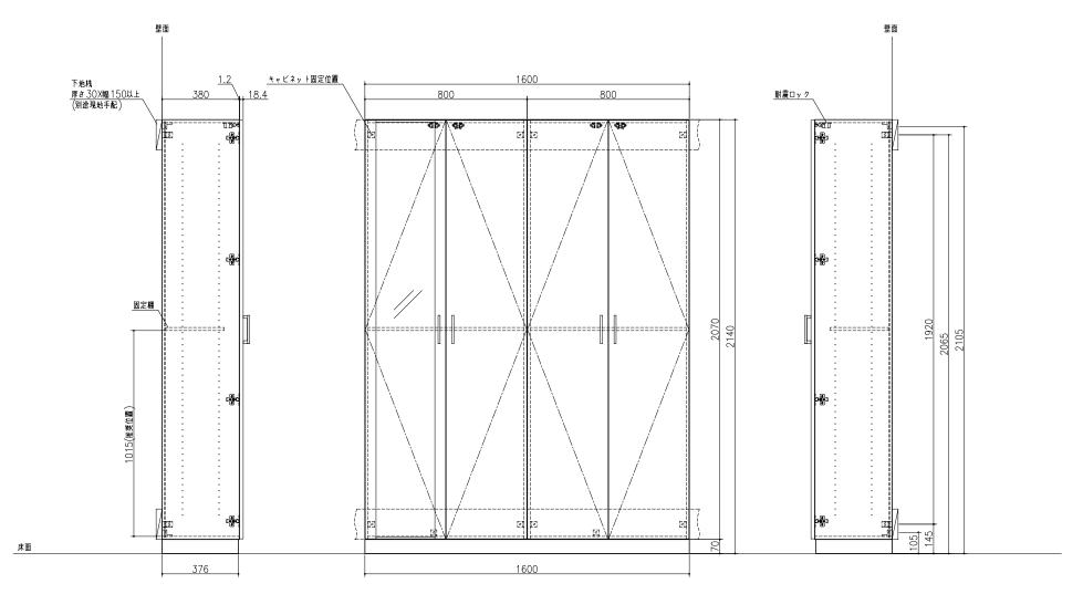
☀倒れの原因となりますのでキャビネットは固定用ねじ(φ4X65)で壁面にしっかり固定してください。
